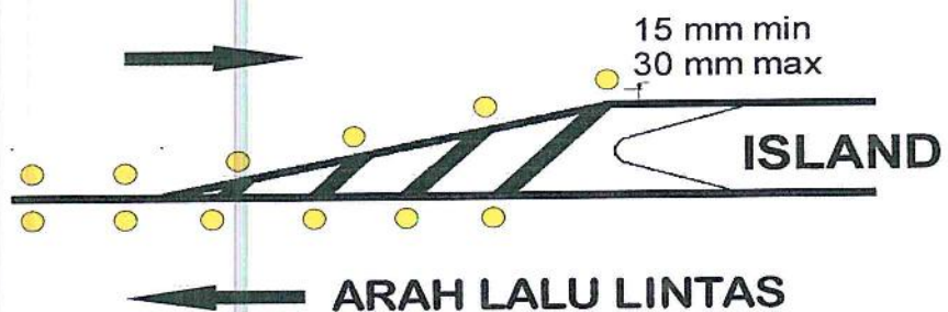
Gambar 9. Paku Jalan dipasang pada marka pengarah lalu lintas untuk pemisah jalur
