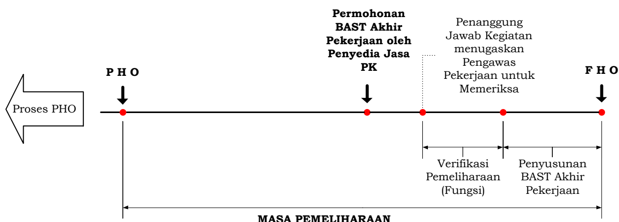
Gambar B.6 Tahapan Serah Terima Akhir Pekerjaan
