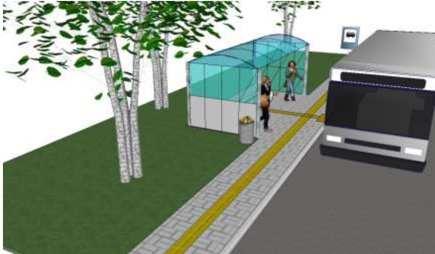
Gambar 7 - Contoh halte yang terletak di belakang jalur pejalan kaki
